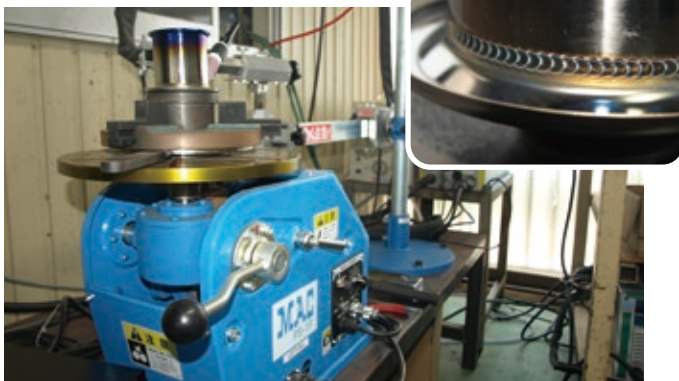
▲同社が導入したデジタル溶接システム。品質の均一化と作業速度の向上が同時に図れる。右上の写真は本システムにより行った溶接部品。溶接歴数十年の熟練工の仕上げにも引けを取らず、見た目の美しさと強度を持ち合わせています。
