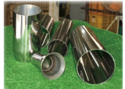
▲同社が開発したロールベンダーにて加工された金属筒。巻き始めから終わりまでがキレイに仕上げられています。
