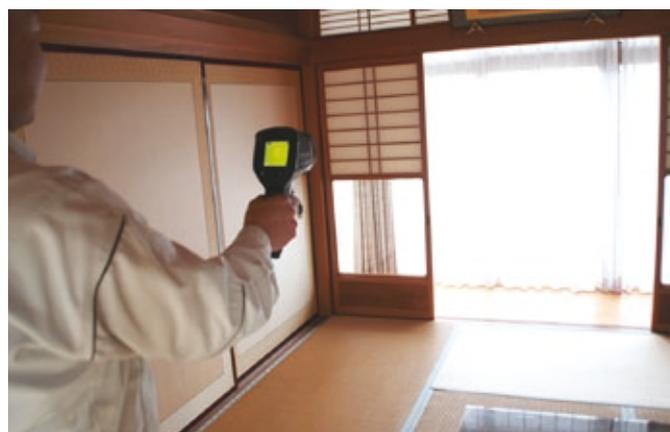
▲サーモグラフィーを使った住宅の断熱性診断の様子。
